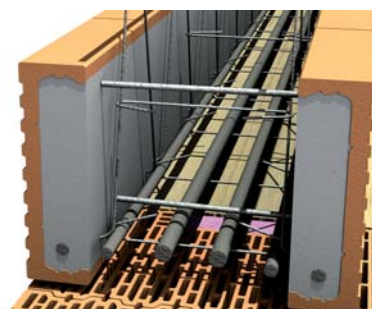
Zkompletovaný překlad KP XL před betonáží
