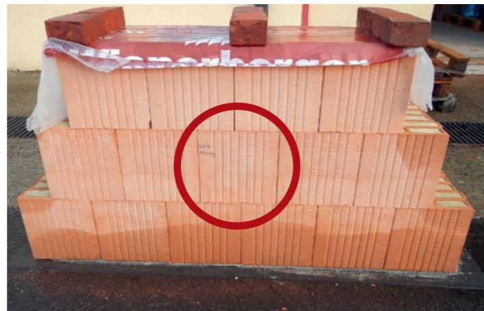
Obr. 23 Při dalším dešti došlo ke zmáčení fragmentu odspoda
