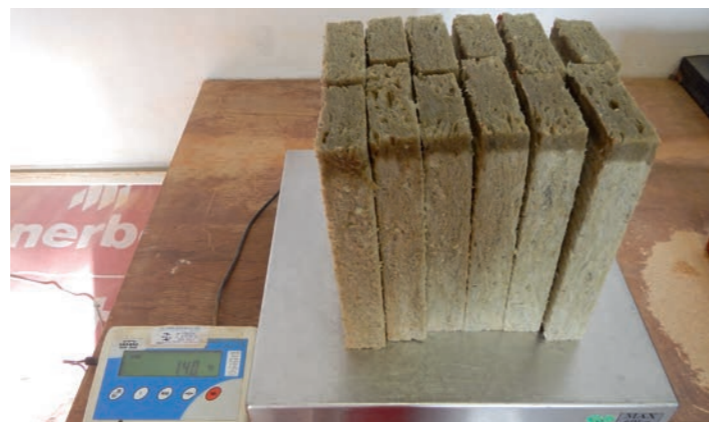
Obr. 6 Vážení minerální vaty z jedné cihly po ukončení zkoušky
