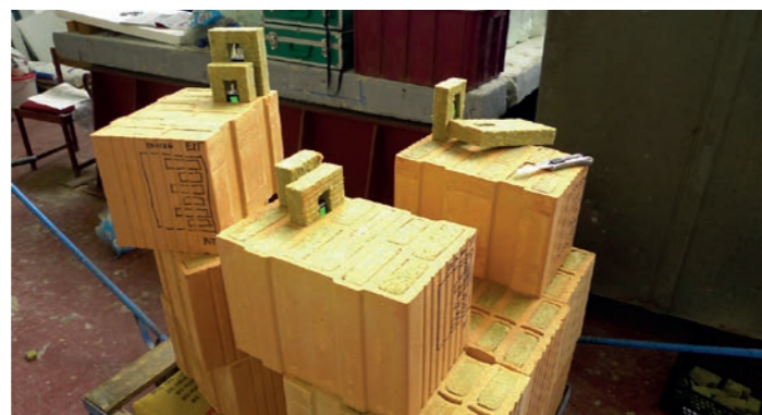
Obr. 27 a 28 Fragment rozdělený na dvě poloviny svisle oddělené hydroizolací (na omítnutou a neomítnutou část)
