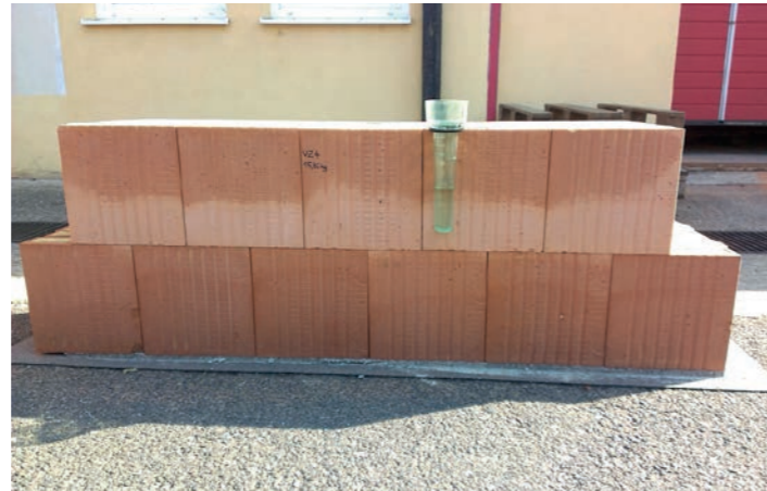
Obr. 21 Nezakrytá horní řada cihel – na dešti 24 hod, úhrn srážek 17 mm (17 l/m 2 )
