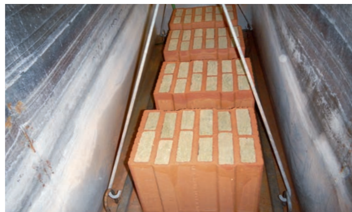
Obr. 4 Vzorky cihel po cca 72 hodinách ve vodě – konec zkoušky. Keramika je zcela nasáknutá
