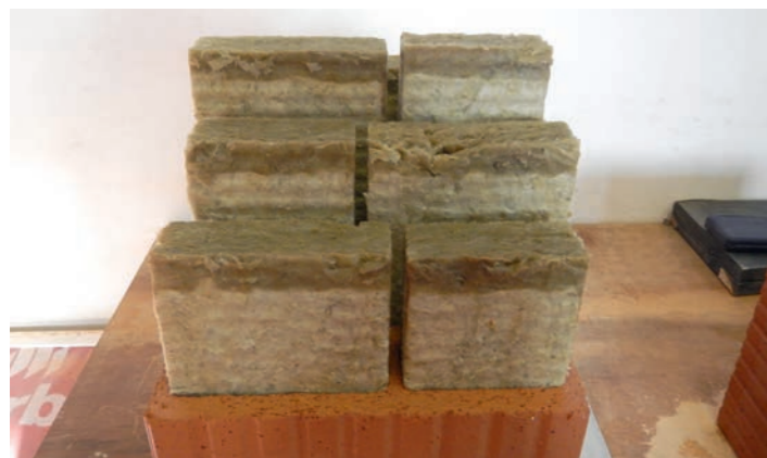
Obr. 5 Minerální vata povytažená z cihly po ukončení zkoušky (cihla otočena vzhůru nohama)
