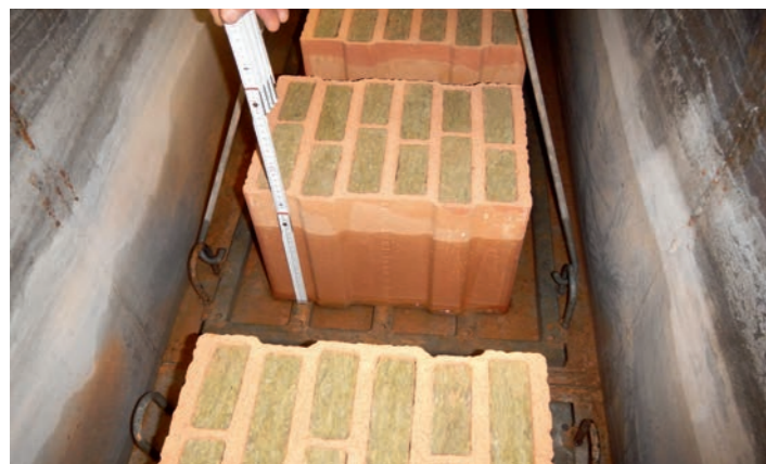
Obr. 3 Vzorky cihel po cca 8 hodinách máčení ve vodě s výškou hladiny cca 30 mm nad spodním okrajem cihel
