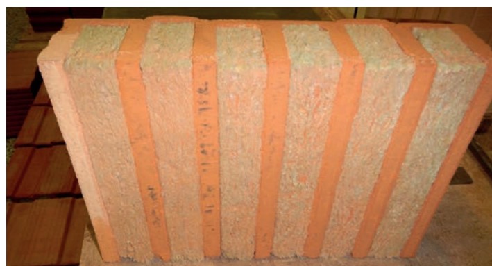
Obr. 11 Řez vzorkem cihly po ukončení zkoušky (po 72 hodinách); žebra tvarovky jsou nasáknutá vodou, lamely minerální vaty jsou úplně suché
