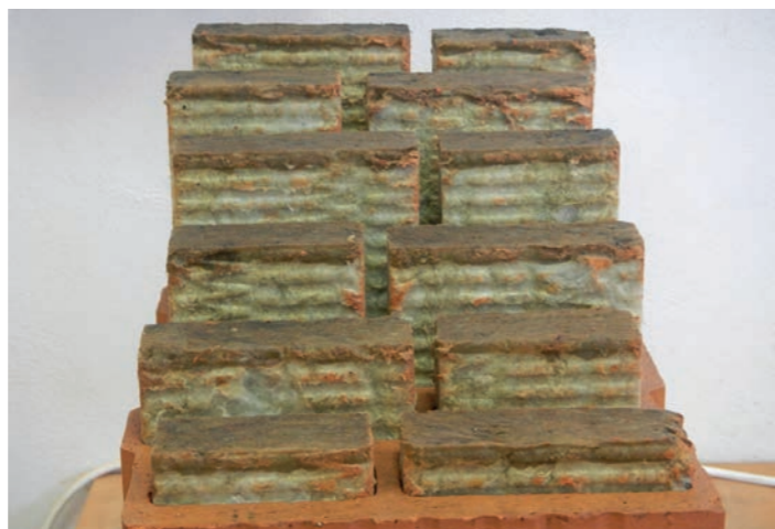
Obr. 17 Vzhledově minerální vata po dešti bez poškození – shora cca 1 cm vlhká (obr. vlevo), zespodu cca 1 cm mokrá (obr. vpravo)
