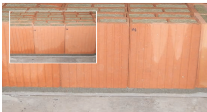
Obr. 10 Postupné vztlínání vody na vnější straně vzorků
