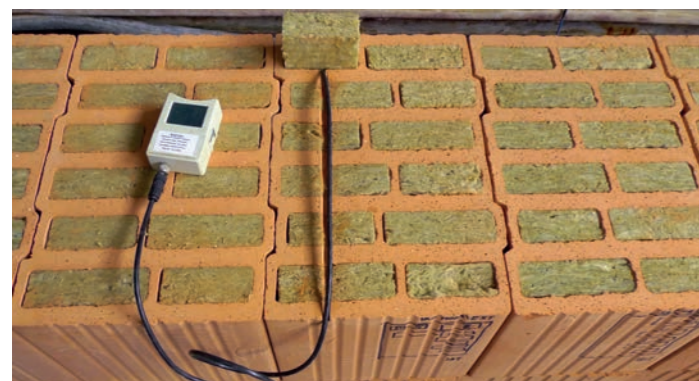
Obr. 29 a 30 Zabudované snímače vlhkosti
