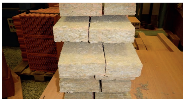
Obr. 12 Vážení minerální vaty z jedné cihly po ukončení zkoušky
