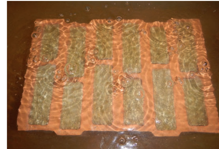
Obr. 24 Vzorek ponořený do vody na 72 hodin
