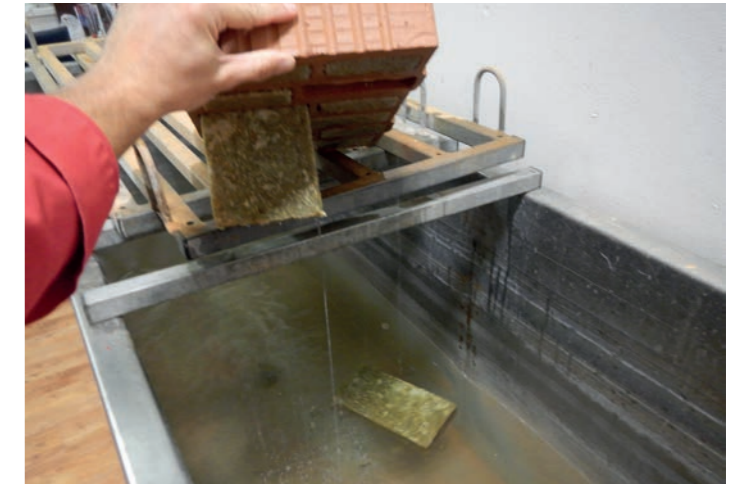
Obr. 25 Po vyjmutí z vody se voda nechala odtéct
