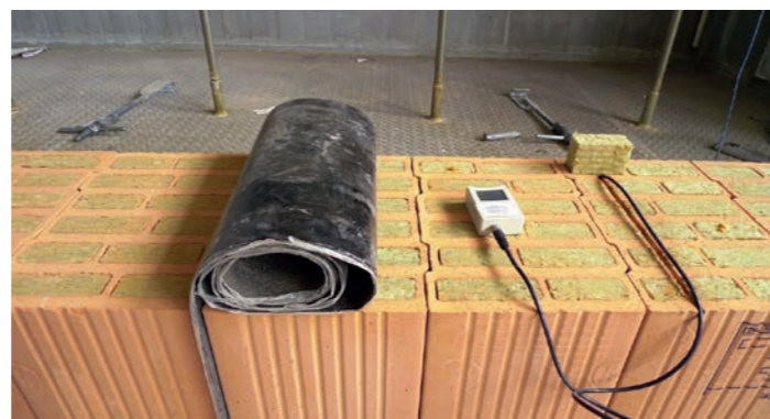
Obr. 27 a 28 Fragment rozdělený na dvě poloviny svisle oddělené hydroizolací (na omítnutou a neomítnutou část)
