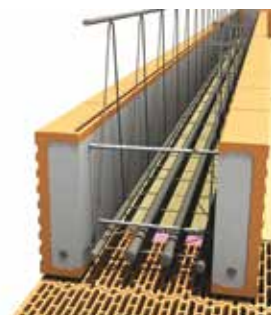
Umístění vzpěr a doohnutí všech třmínek
